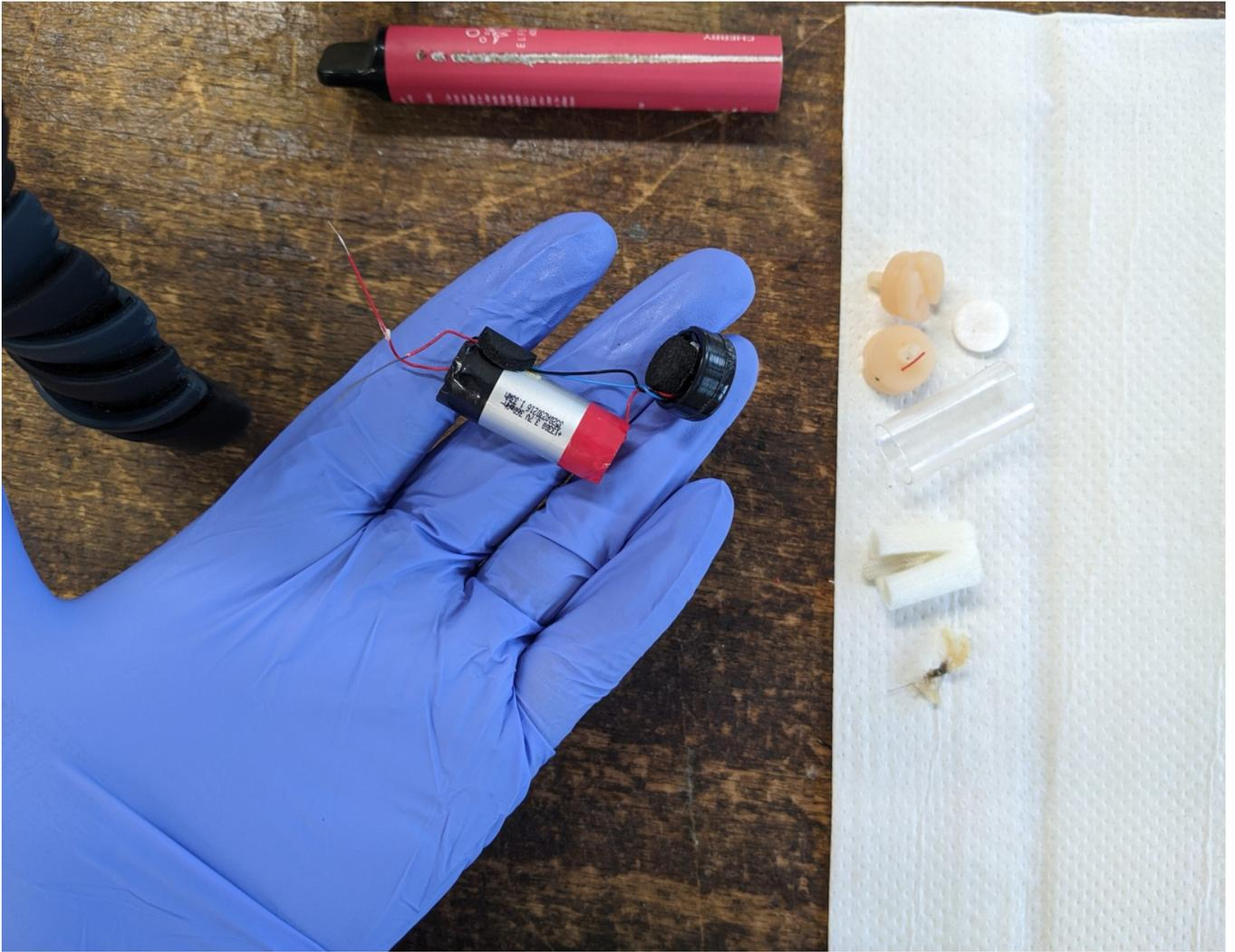
4. Das rote und schwarze Kabel vom Boden der E-Zigarette abschneiden, sie sollten möglichst lang bleiben. Achtung: Die Kabel nacheinander durchschneiden, sonst kommt es zum Kurzschluss.
