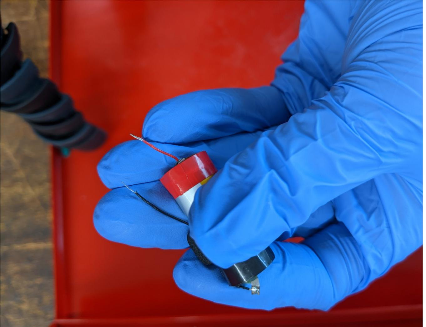
2. In einer Dritten Hand Platine und Kabel befestigen. Kabel mit abisoliertem Drahtende in entsprechendes Loch von Platine stecken (B+/B-). Achtung: schwarz = Minus, rot = Plus.
