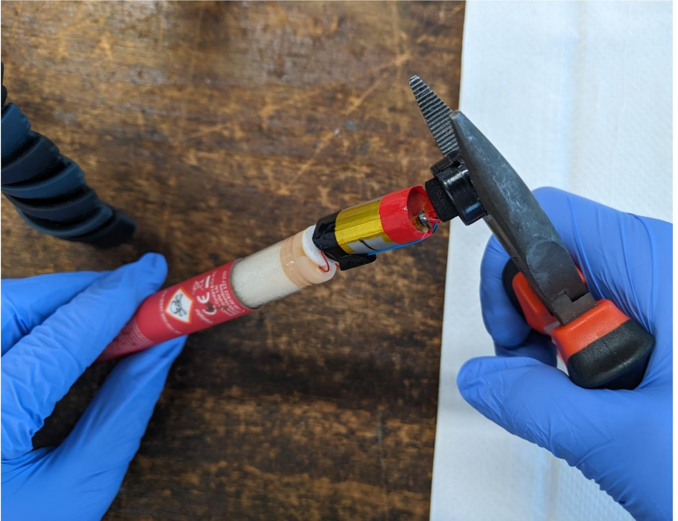
3. Alle überschüssigen Teile (Filter, usw.) entfernen, diese kommen in den Müll. Übrig bleibt der Akku mit Kabeln.
