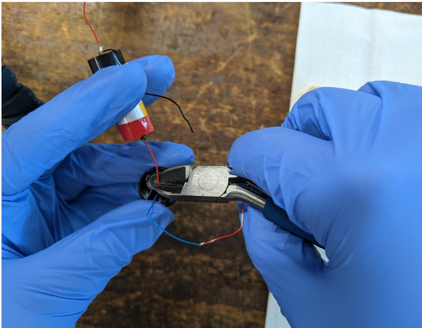
5. Das rote Kabel, welches sich am Minuspol des Akkus befindet, entfernen. Es wird nicht benötigt.
