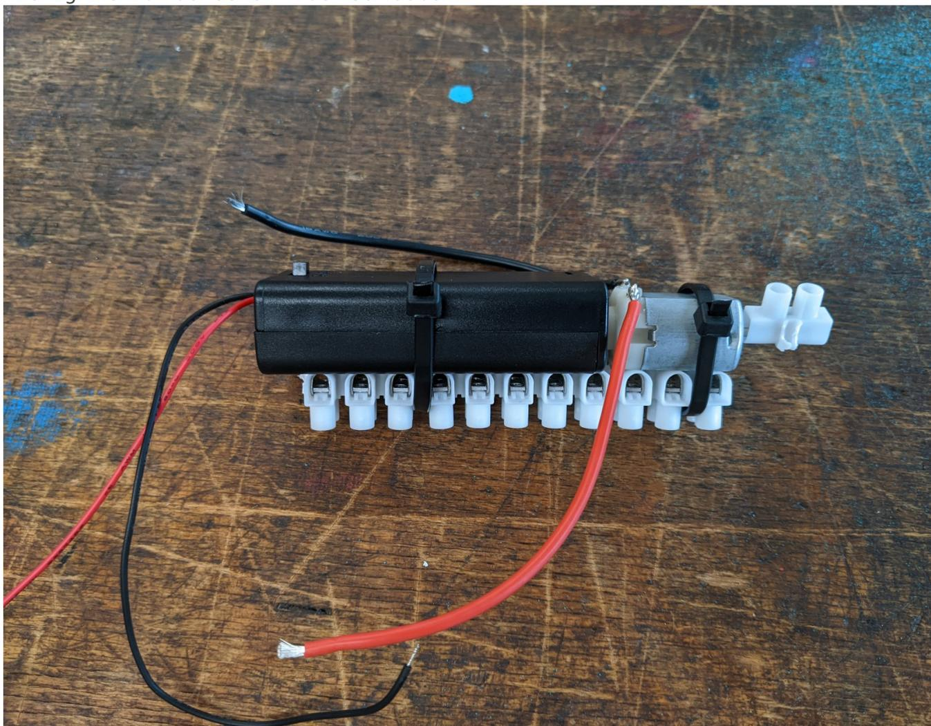
6. Die Kabel vom Batteriehalter und vom Motor in der Lüsterklemme befestigen. Dabei beachten, dass die Kabel vom Motor sich auf der einen Seite befinden müssen und die Kabel vom Batteriehalter auf der gegenüberliegenden Seite.
