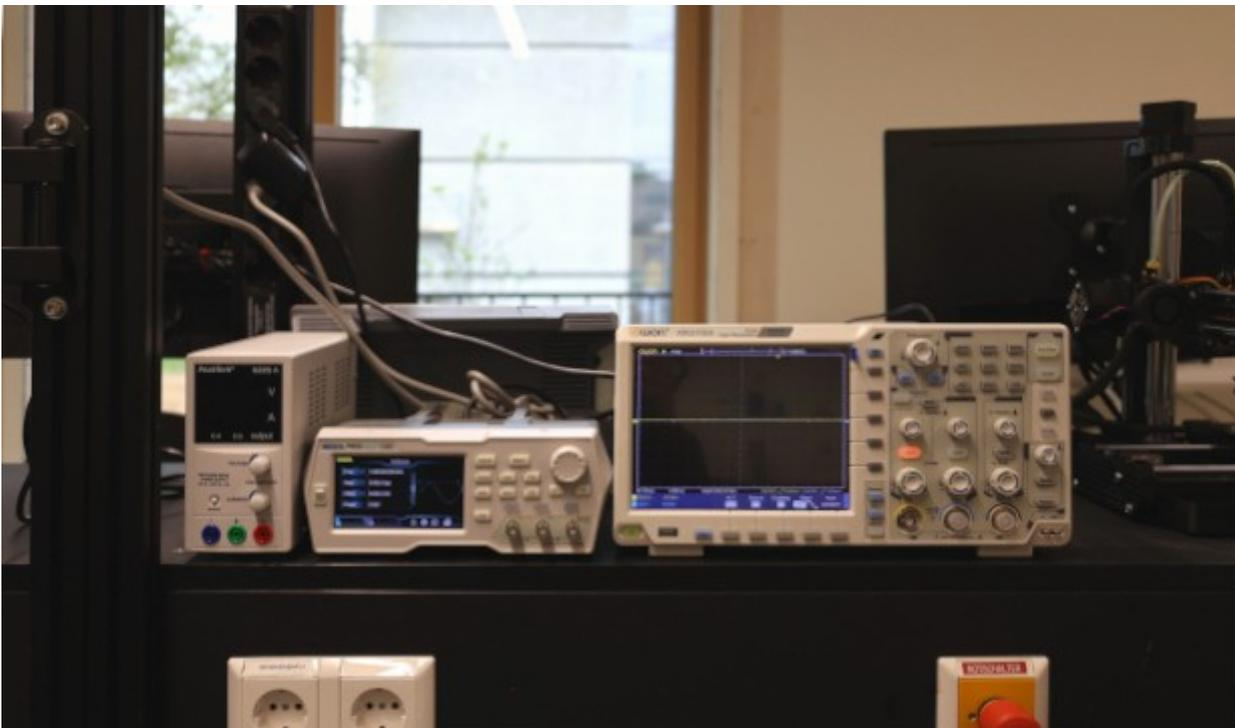
Das Schaltnetzgerät befindet sich im Bild auf der linken Seite.
